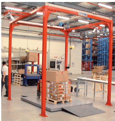
Volumenportal, Bodenwaage mit Auffahrrampe
