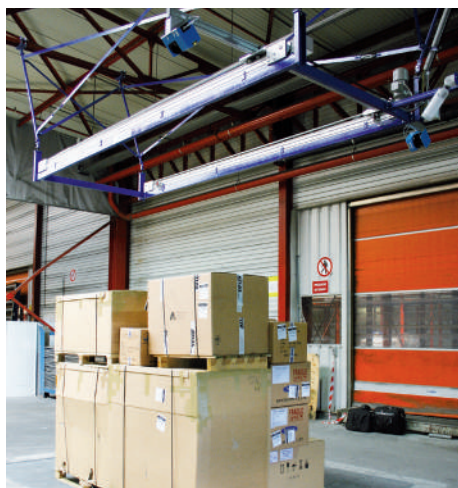
Deckenmodul Volumen, Bodenwaage eingebaut
